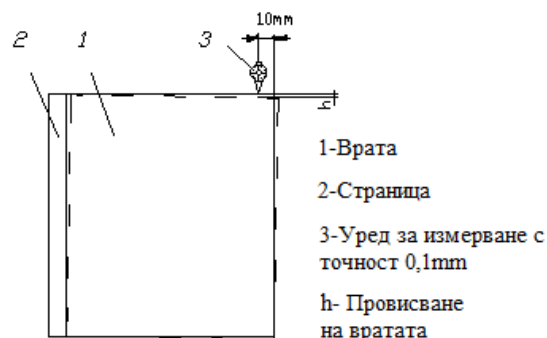
Фиг. 2. Принципна схема за измерване на провисването
